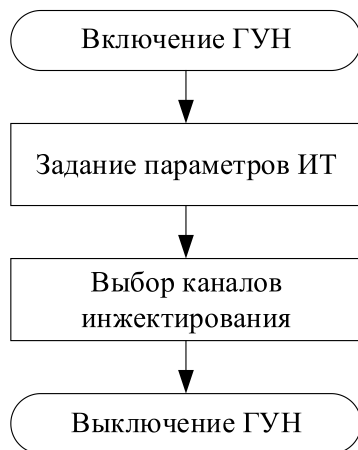
Рис. 2. Блок-схема работы блока инжектирования
